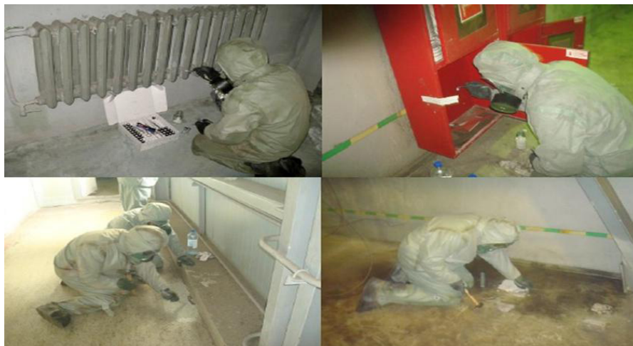
Рис. Отбор проб на объектах по уничтожению химического оружия
